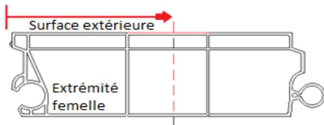
**Étape 2.** Découpez la hauteur du panneau à l'aide de la scie sauteuse et en suivant la ligne tracée.
