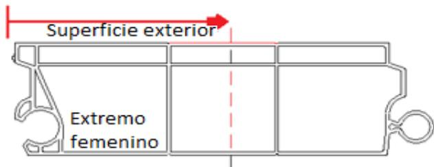
**Paso 2.** Corte la altura del panel utilizando la sierra de calar y siguiendo la línea marcada.
